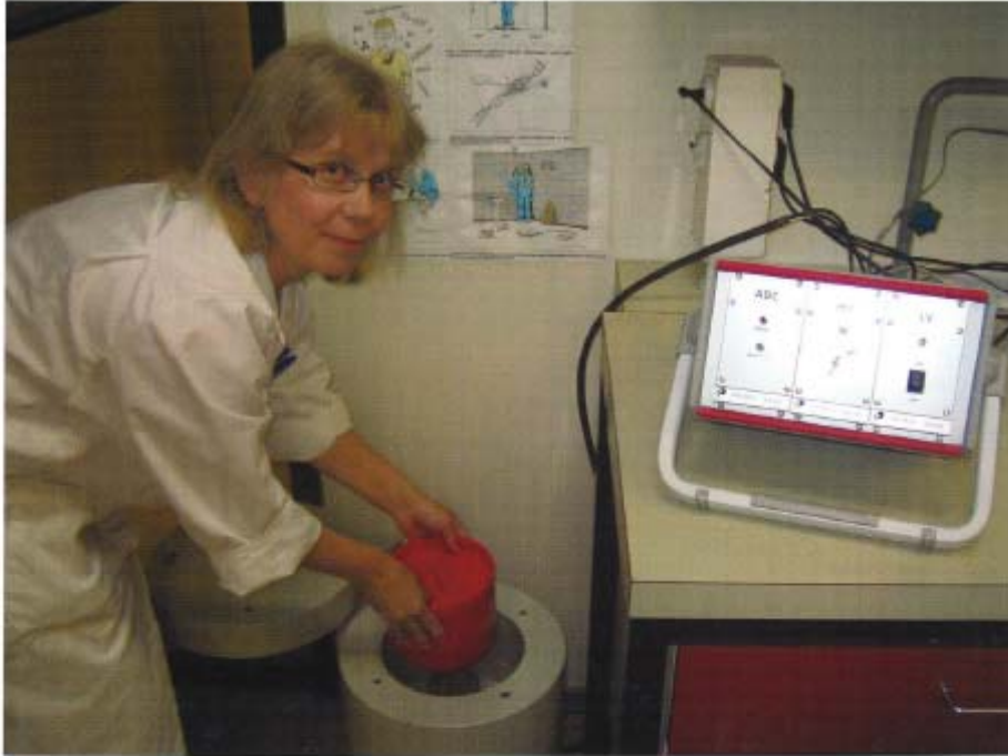
Kuva 1. Laborantti Virpi Tuominen mittaa sienien radioaktiivisuutta Tullilaboratoriossa venäläisellä RADEK-gammaspektrometrillä, joka kuuluu Suomessa elintarvikevalvontalaboratorioiden perusvarustukseen.
